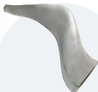
Bord d'attaque de l'aube fan composite du moteur LEAP
